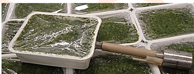
Contrôle à cœur par capteur embarqué radio
